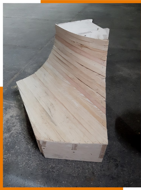
Podbudowa z deszczułek
